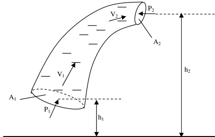
Para elevar o líquido de uma altura “ $h_1$ ” para outra “ $h_2$ ” deve-se exercer uma pressão “ $P_1$ ” e este adquire uma velocidade “ $v_1$ ” e chega ao ponto mais elevado com uma velocidade “ $v_2$ ”. A pressão “ $P_2$ ” pode ser vista como uma contra pressão em relação ao ponto de partida porque se opõe ao movimento do líquido.
