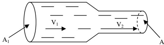
O princípio de continuidade estabelece que durante o escoamento de um fluído ideal (incompressível e não viscoso) a vazão é constante. ( $Q = \text{Constante}$ ). Isto significa que em qualquer ponto do tubo a vazão é a mesma. Por isso podemos escrever:  $Q_1 = Q_2$
