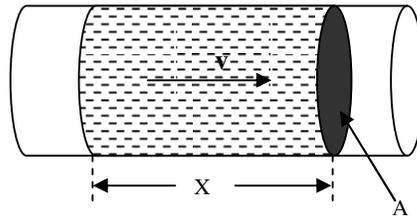
O volume “V” de líquido contido no trecho “x” pode ser calculado pela expressão (volume de um cilindro):  $V = A \cdot X$ ,
