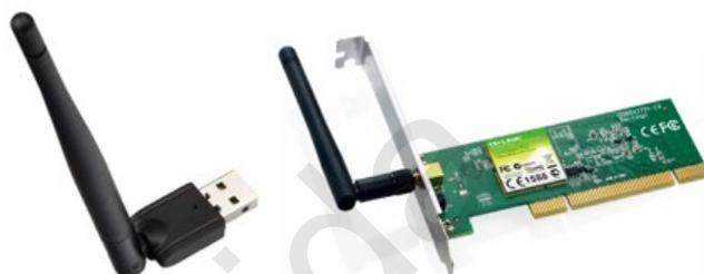
Fig. 79 – Placa de rede sem fio
