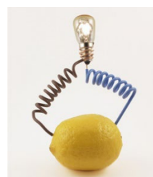
Condução eléctrica por soluções ácidas
