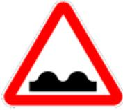
Fig. 17: Lomboa ou depressão: Indicação de deformação acentuada do pavimento da via.
