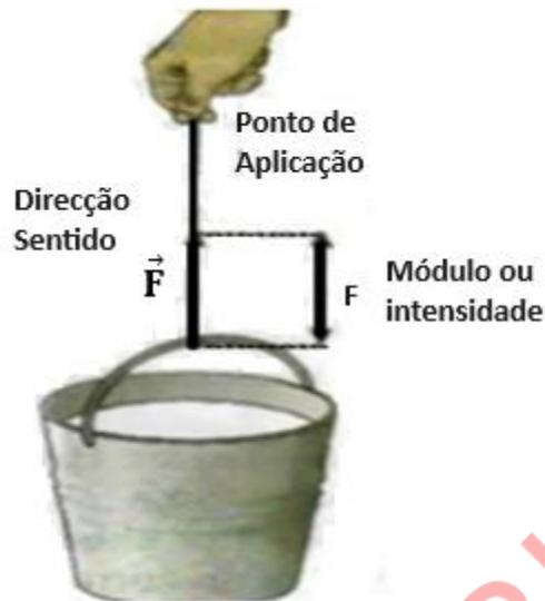
**Figura 6:** Elementos de uma força aplicada num balde de água
