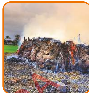
Figuras 29 - Uso do feno para a cozedura de peças
